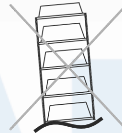
Не ровный пол. Эксплуатация запрещена.
